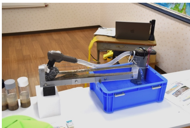
写真1：水の流れて動く砂粒を観察する装置。
