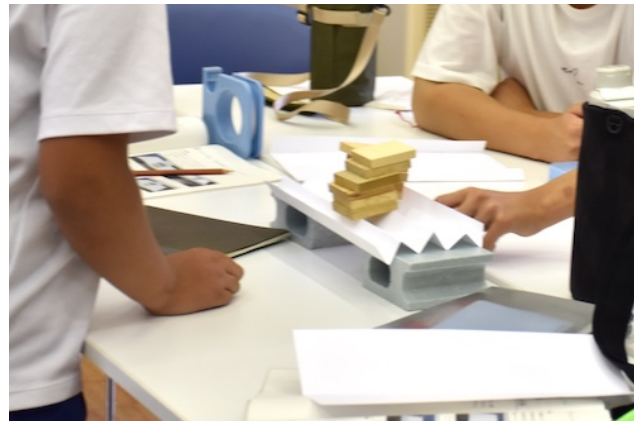
写真5：紙の形を変えて強さの違いを調べる実験。
